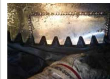
**Schritt 2:** Das maßgefertigte Ersatz-Segment wurde eingesetzt und mit speziellen Gewindestiften fixiert.
