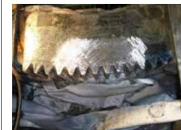
**Schritt 3:** Die überstehenden Teile sind abgeschert worden, nun kann die Fläche geschliffen werden.
