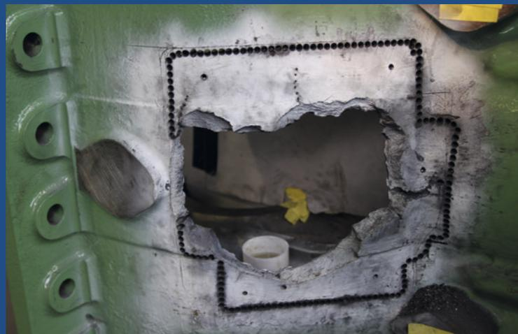
Für so umfangreiche Schäden ist das in den 1930er-Jahren in den USA entwickelte Metallock-Verfahren die einzige Lösung. Die Stelle wird zunächst ausgearbeitet
